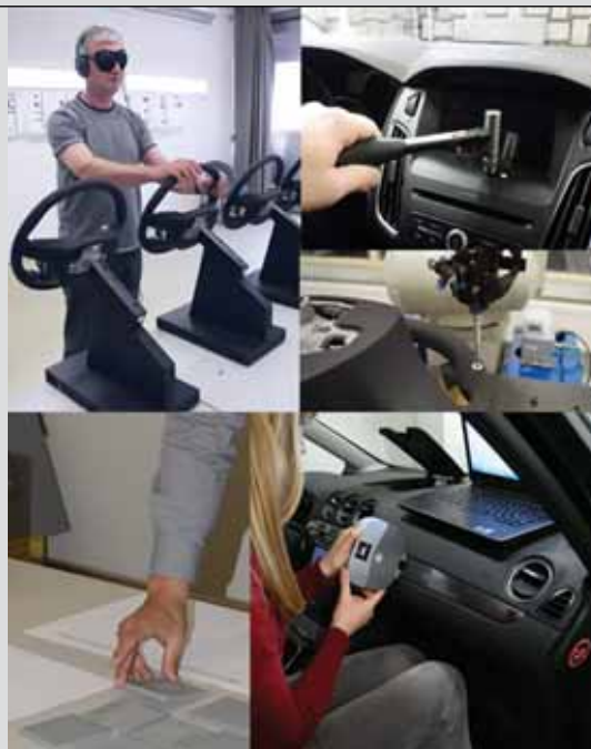
Рисунок 1. Субъективная и объективная оценка воспринимаемых качеств разных сенсорных модальностей является главным вопросом современного промышленного дизайна и оптимизации внешних свойств выпускаемых товаров. Сверху вниз слева направо: осязательная оценка с закрытыми глазами и ушами, измерение акустической чувствительности поверхностей и осязательной мягкости, оценка внешнего облика поверхности, оценка воспринимаемой температуры
