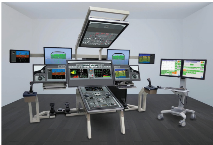
Рис. 4. Универсальный стенд прототипирования кабины экипажа Государственного НИИ авиационных систем
