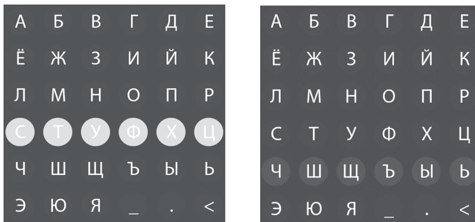
Рис. 2. Варианты подсветок на примере элементов без обрамления: а – высокоинтенсивная подсветка строки, б – низкоинтенсивная подсветка строки (вторая строка снизу)
